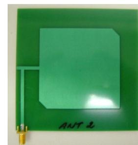
Protótipo de antena para leitor portátil
